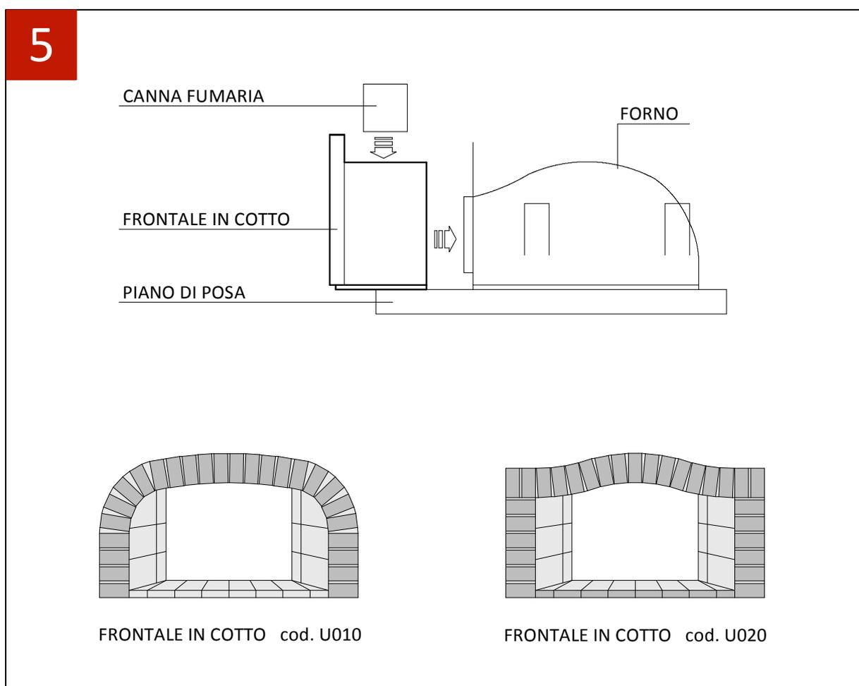
**PER I MODELLI P140 E P140L, LA SOLUZIONE CHE REALizzerETE SUL POSTO PER L'USCITA DEI FUMI DOVRA' PREVEDERE UNA CANNA FUMARIA DI DIAMETRO MINIMO DI 30 cm.**
